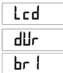
Vous pouvez modifier la durée et la luminosité du rétroéclairage de l'afficheur.
