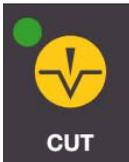
Le meilleur courant pour la coupe c'est la sinusoïdal sans modulation, avec duty-cycle 100%. Ce courant est indiqué pour la coupe sans coagulation.
