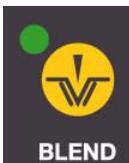
Le courant (BLEND) est indiqué pour la coupe coagulée quand on désire une coagulation profonde associée à la coupe. Ce courant est constitué par le courant sinusoïdal indiqué à la coupe associée à la coagulation à basse tension (soft coag). Avec ça on obtient un courant indiqué à la coupe coagulée.
