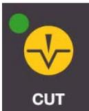
Le meilleur courant pour la coupe c'est la sinusoïdale sans modulation, avec un duty-cycle de 100%. Ce courant est indiqué pour la coupe sans coagulation.
